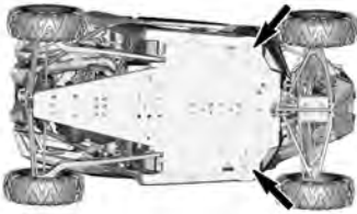
POSICIONES DEL SOPORTE DEL GATO - PARTE DELANTERA DEL VEHÍCULO
