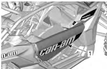
1. Puerta cerrada y correctamente bloqueada.
