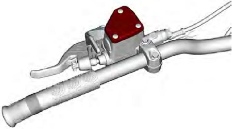
2. Retirez les vis fixant le bouchon de réservoir.
