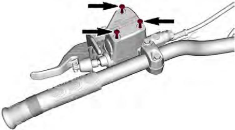
3. Retirez le bouchon de réservoir.
