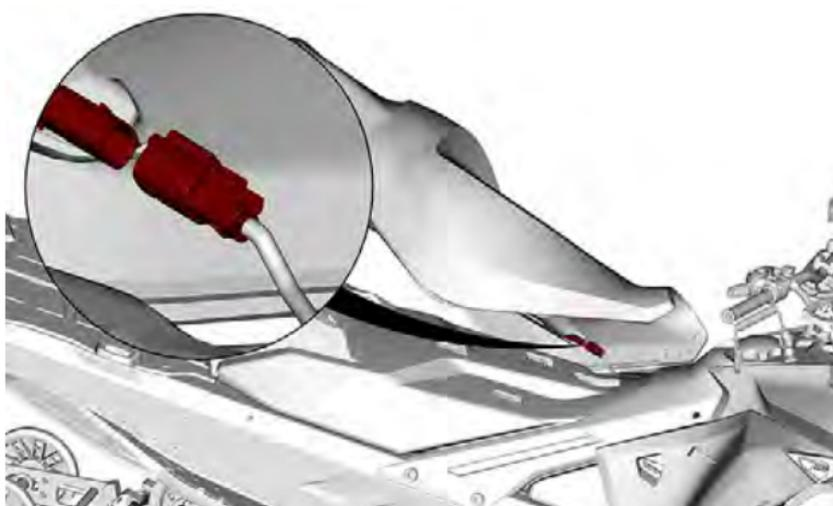
*Installation du siège – Verrouillage de la languette avant*
