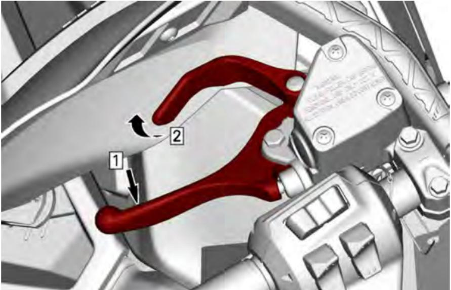
**TYPIQUE — ENGAGER LE MÉCANISME**
