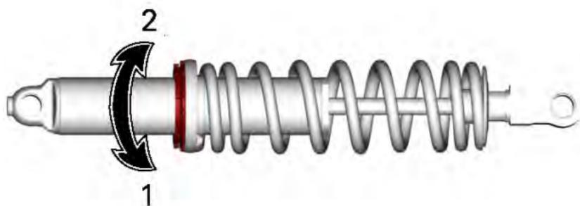
1. Vorspannung erhöhen
