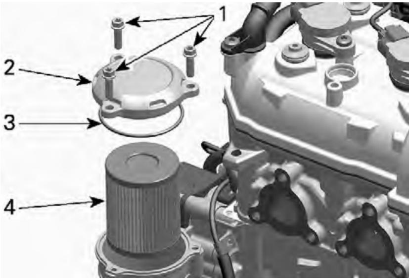
1. Schrauben der Ölfilterabdeckung
