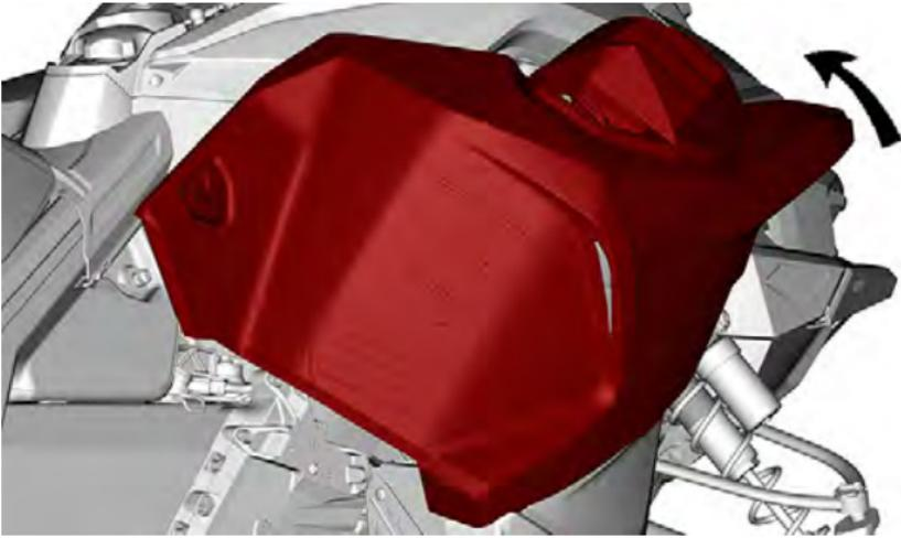
3. Sichern Sie die Seitenverkleidung mit den Verriegelungen.
