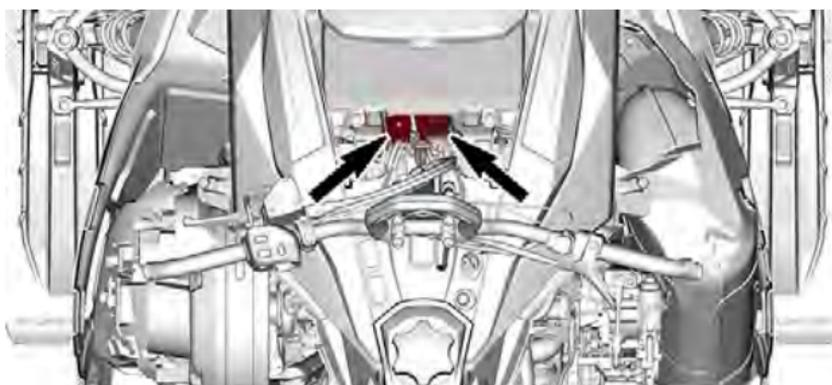
5. Entfernen Sie die folgenden Befestigungselemente.
