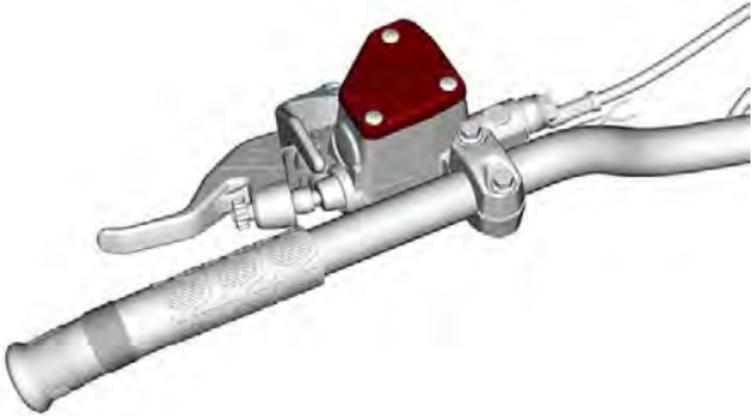
2. Entfernen Sie die Halteschrauben des Behälterdeckels.
