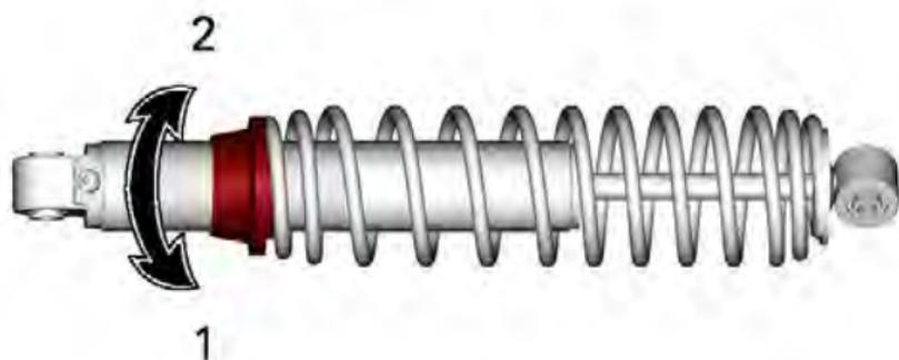
1. Vorspannung erhöhen
