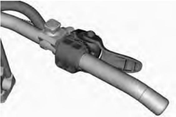
**GASHEBELPOSITION FÜR FINGERBETÄTIGUNG**
