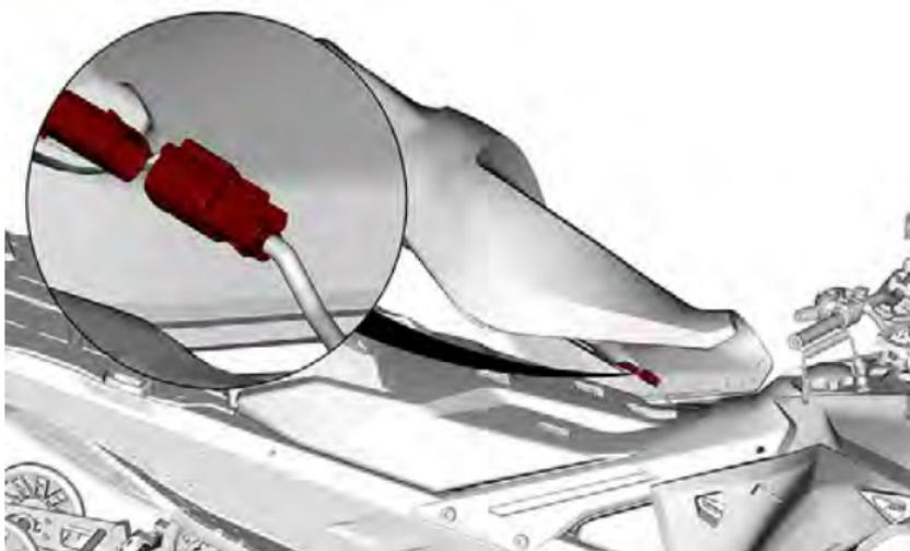
2. Setzen Sie den Sitz auf die Haken und schieben Sie ihn dann nach vorne, bis die Sperrzunge auf dem vorderen Haken einrastet.
