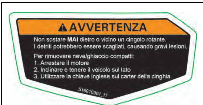
CINGOLO A ROTAZIONE - ETICHETTA DI AVVERTENZA
