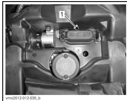
1. Lokk for sikringsholder bak
