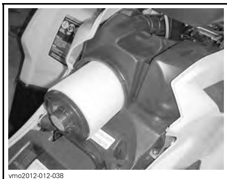
FJERNING AV LUFTFILTER
