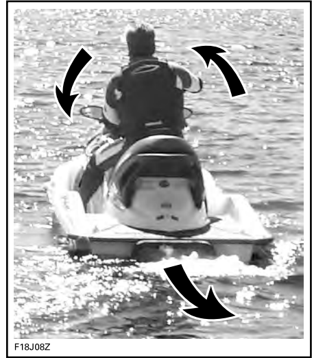
TYPBILD - STYRRIKTNINGEN OMKASTAD VID BACKNING
