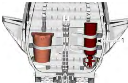
1. Extintor de incêndio
