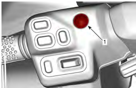
TYPISCH – MOTORSTART/ STOPSCHAKELAAR
