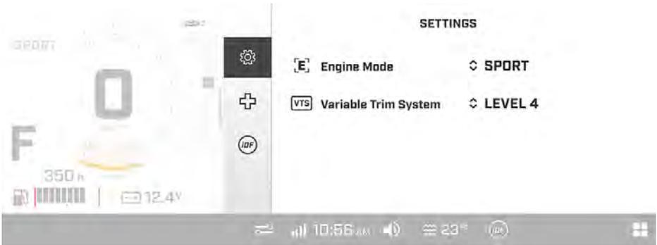
**NOTA:** Al cambiar la posición de ajuste del sistema VTS sin que el motor esté en posición de avance, solo cambia la indicación. La tobera se desplazará a la posición de ajuste del sistema VTS seleccionada cuando se acciona el modo de impulso de avance.
