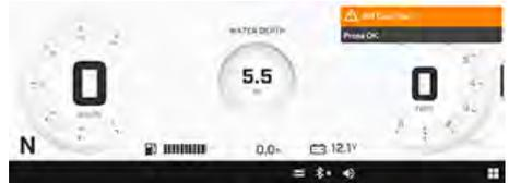
6. El modo Anulación de iBR ahora está activo. Utilice el botón del interruptor multifunción para mover la compuerta del iBR. La ubicación de la compuerta puede controlarse mediante la pantalla digital.
