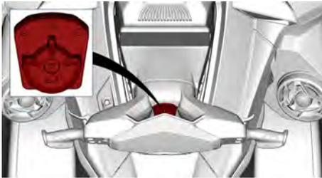
El amortiguador de la dirección tiene tres niveles de amortiguación.
