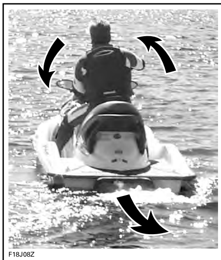
典型示例 - 后退时转向方向相反
