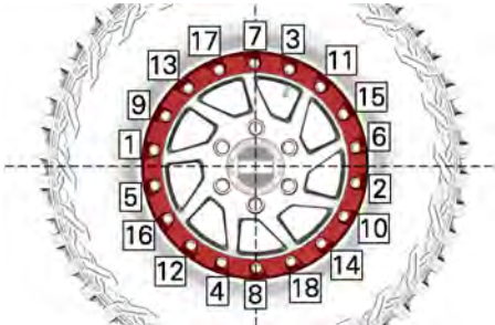
TYPISCH - AANDRAAIVOLGORDE
