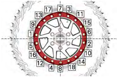
SITUAZIONE TIPICA - SEQUENZA DI SERRAGGIO
