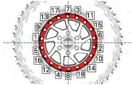
SITUAZIONE TIPICA - SEQUENZA DI SERRAGGIO
