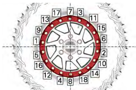
SITUAZIONE TIPICA - SEQUENZA DI SERRAGGIO
