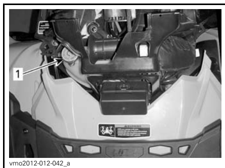
1. Réservoir de liquide de refroidissement
