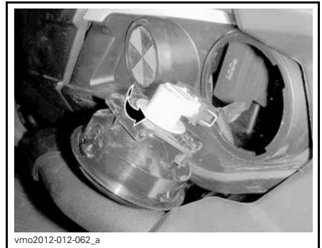
FAIRE TOURNER L'AMPOULE DANS LE SENS ANTIHORAIRE
