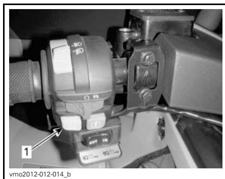
1. Dispositif de neutralisation/DPS/ACS
