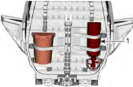
1. Extintor de incêndio
