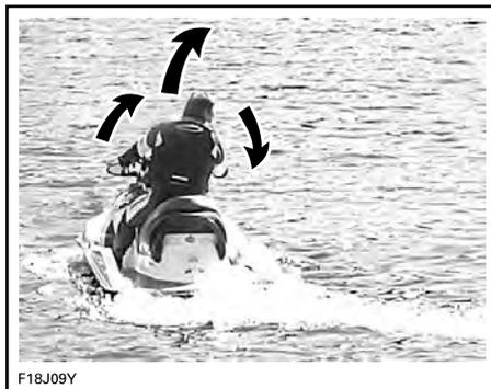
ハンドルバーを回すと、ジェットポンプノズルが軸を中心に向きを変え、ウォータークラフトの進行方向を制御します。ハンドルバーを右に切ると、ウォータークラフトは右へ旋回し、左に切れれば左に旋回します。操船にはスロットルを回していることが必要です。
