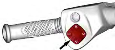
**可変トリムシステム (VTS) ボタン**
