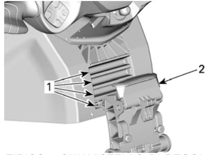
**TIPICO - CHIAVISTELLO DI REGOLAZIONE DELLA COLONNA DELLO STERZO CORRETTAMENTE FISSATO**
