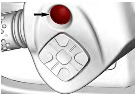
典型示例 - 发动机 START/STOP ( 起动 / 停止 ) 按钮
