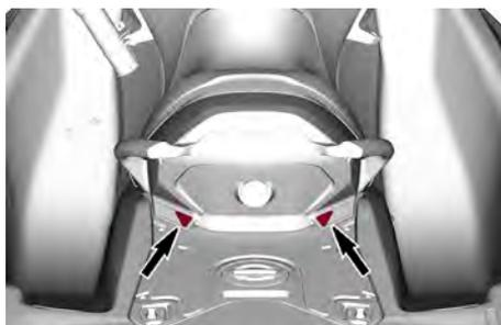
2. 然后拉起解锁手柄，拆下摩托艇上的前部座椅。
