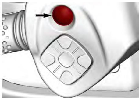
TIPICO – PULSANTE START/STOP MOTORE
