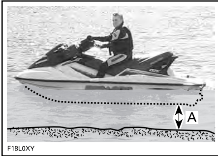
A. Sorgen Sie dafür, dass mindestens 90 cm (3 ft) Wasser unter dem am tiefsten liegenden hinteren Teil des Rumpfes liegen, wenn alle Mitfahrer an Bord sind
