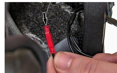
6. Reconecte o conector VERMELHO do microfone no conector VERMELHO da unidade principal.
