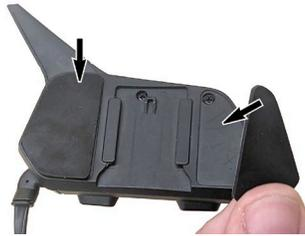
3. Desconecte os dois alto-falantes e o microfone do módulo principal, puxando em ambas as extremidades do conector.
