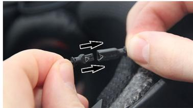
**A.8.** Certifique-se de que o cabo do alto-falante passe por trás do revestimento e não interfira ao colocar ou remover o capacete.
