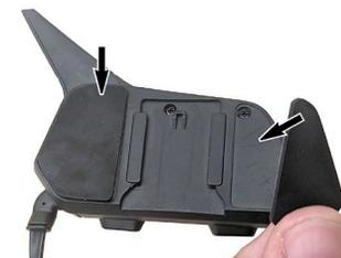
3. Desconecte os dois alto-falantes e o microfone do módulo principal, puxando em ambas as extremidades do conector.
