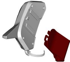
2. Selecione os 2 adesivos de borracha de um lado e instale-os na parte traseira do dispositivo.
