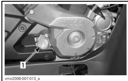
TYYPILLINEN - MOOTTORIN OIKEA PUOLI 1. Mittatikku
