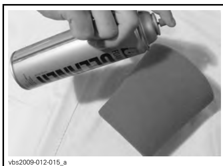
TYYPILLINEN - SUIHKUTA VAAHTOMUOVISUODATTIMEEN
