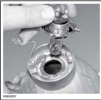
1. Posizione della presa del faro 2. Alloggiamento del faro
