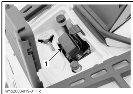
1. Boîte de fusibles avant
