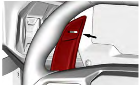
LINKE SCHALTWIPPE HERABSCHALTEN
