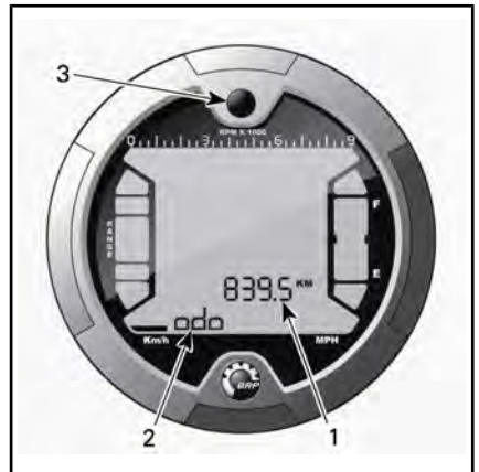
1. Anzeige 2 (Modus) 2. Anzeige 3 (Modus/Mitteilung) 3. Auswahltaste
