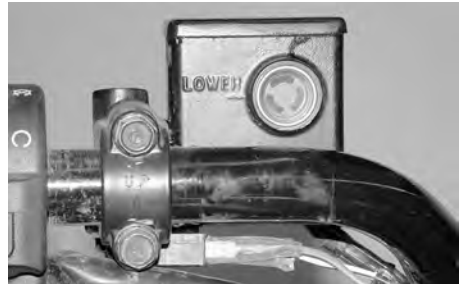
TYPISCH — ACHTERREM-VLOEISTOFRESERVOIR LINKS
