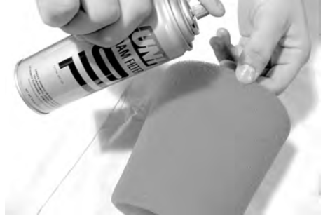
TYPISCH - FILTERELEMENT MET OLIE SMEREN
