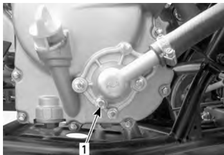
1. Tappo di scarico del sistema di raffreddamento
