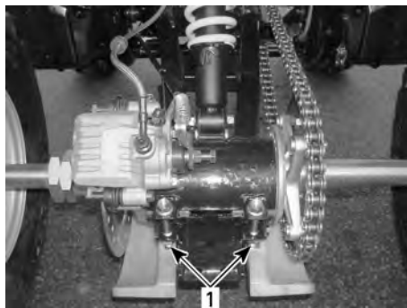
1. Bulloni di blocco del tendicatena
