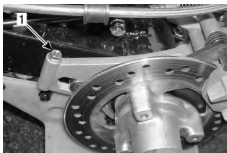
1. Bullone di supporto della pinza
