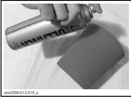
vbs2009-012-015_a TYPIQUE - IMPRÉGNER L'ÉLÉMENT EN MOUSSE
