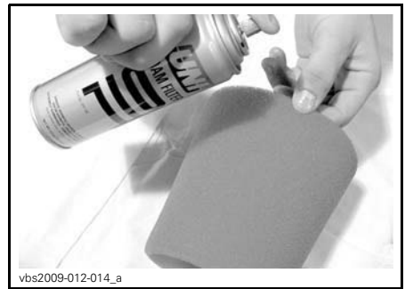
vbs2009-012-014_a TYPIQUE - HUILER L'ÉLÉMENT EN MOUSSE
