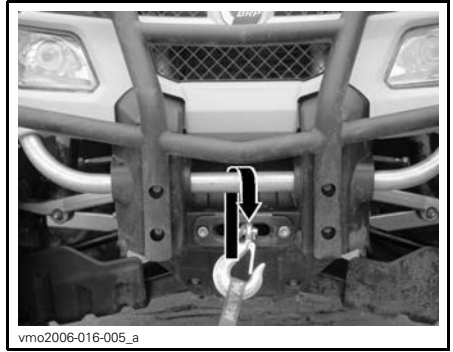
TYPIQUE — EMPLACEMENT DE L'ARRIMAGE AVANT
