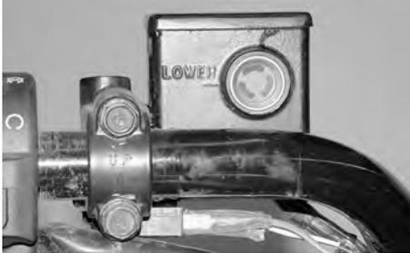
TÍPICO — DEPÓSITO DE LÍQUIDO DE FRENOS DE LA PARTE TRASERA, EN EL LADO IZQUIERDO
