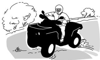
Si el vehículo derrapa o resbala, puede resultar de utilidad girar el manillar en la dirección del deslizamiento hasta que vuelva a recuperar el control. Procure que no se bloqueen nunca los frenos ni las ruedas.
