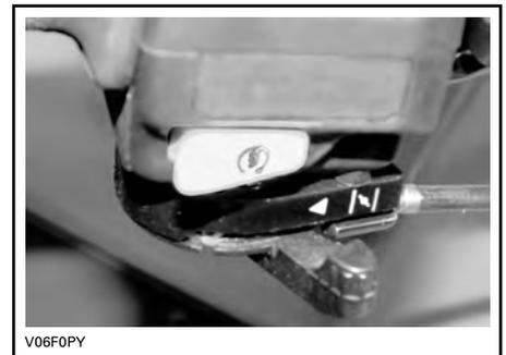
CHOKE GEÖFFNET, HEBEL IN UNBETÄTIGTER STELLUNG
