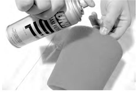
**TYPISCH - SCHAUMFILTERELEMENT ÖLEN**
