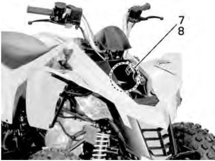
ZUGRIFFSELEMENT AM VORDEREN KOTFLÜGEL
