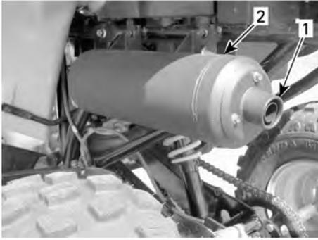
1. Ausgang des Auspufftopfs entfernen
