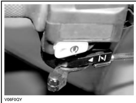
**CHOKE IN VOLLSTÄNDIG GEÖFFNETER STELLUNG**
