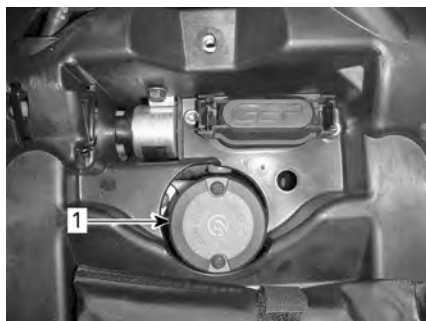
1. Serbatoio liquido dei freni posteriori
