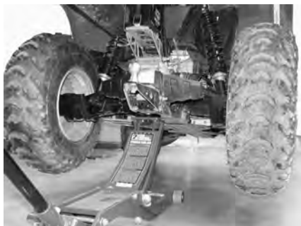
CONFIGURAZIONE TIPICA - PUNTO DI SOLLEVAMENTO POSTERIORE
