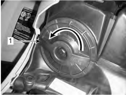
1. Copertura filtro dell'aria
