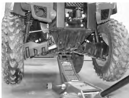
CONFIGURAZIONE TIPICA - PUNTO DI SOLLEVAMENTO ANTERIORE
