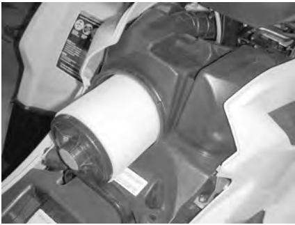
1. Copertura filtro dell'aria
