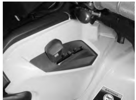
COLLOCAZIONE DELLA LEVA DEL CAMBIO
