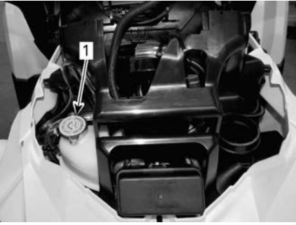
1. Réservoir du liquide de refroidissement
