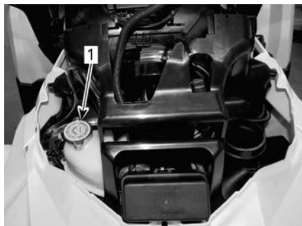
1. Réservoir du liquide de refroidissement
