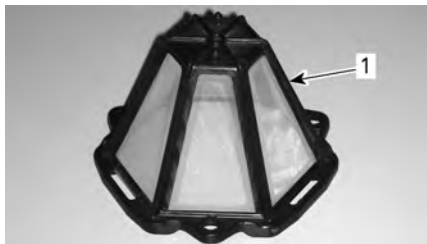
1. Filtre à air de la boîte CVT (type à pince)
