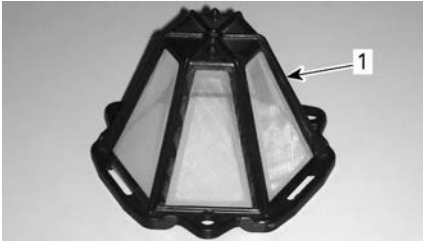
1. CVT:n ilmansuodatin (kiinnitettävä suodatin)
