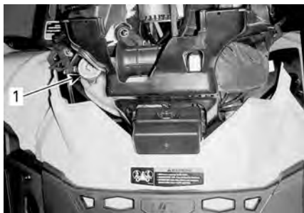
1. Réservoir du liquide de refroidissement
