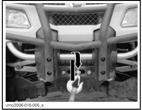
TYPIQUE — EMPLACEMENT DE L'ARRIMAGE AVANT
