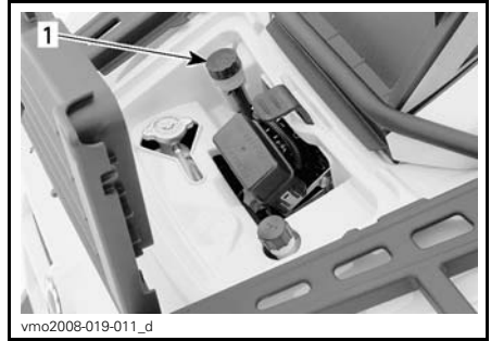
vm02008-019-011_d TYPIQUE — COMPARTIMENT D'ENTRETIEN 1. Réservoir
