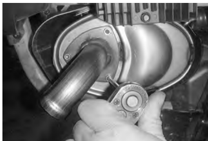
典型示例 - 拆卸尾管
