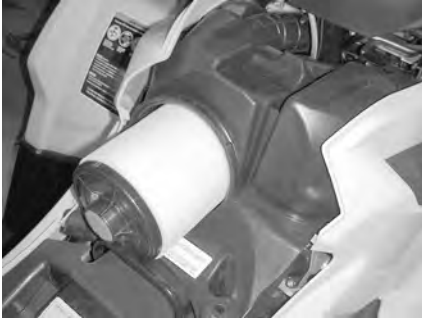
VERWIJDEREN VAN DE LUCHTFILTER
