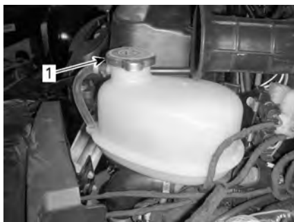
1. Tappo del serbatoio liquido refrigerante motore
