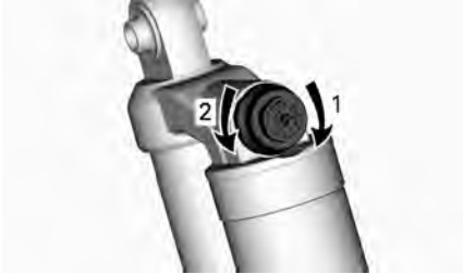
SMORZAMENTO IN COMPRESSIONE - PARTE SUPERIORE DELL'AMMORTIZZATORE
