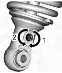
SMORZAMENTO IN ESTENSIONE - PARTE INFERIORE DELL'AMMORTIZZATORE
