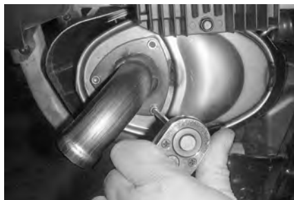
CONFIGURAZIONE TIPICA - RIMUOVERE IL TUBO DI CODA
