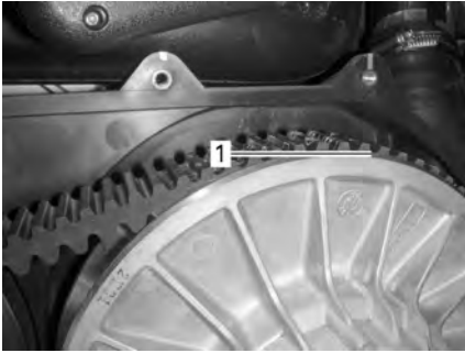
1. Parte inferior de los dientes a la altura de la superficie externa de la correa conductora
