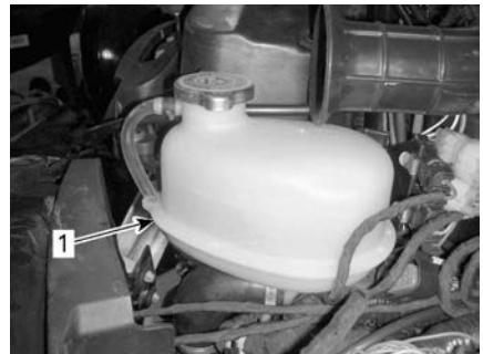
1. Serbatoio liquido refrigerante motore
