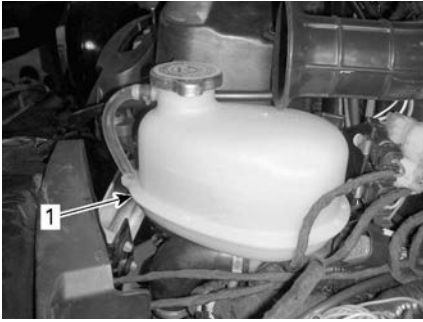
1. Réservoir du liquide de refroidissement
