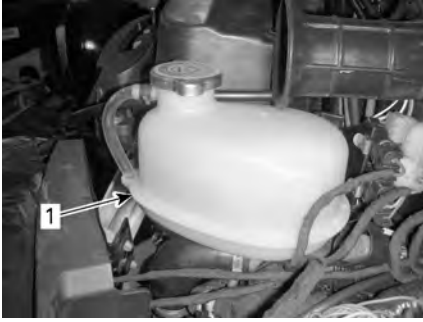
1. Réservoir du liquide de refroidissement
