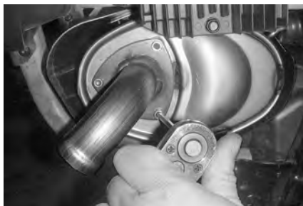
典型示例 - 拆卸尾管
