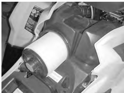
空气滤清器拆卸
