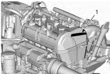
1. Identificação de fabricante do motor
