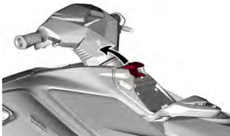
2. Deslize a tampa para cima na direção da alavanca de trava. Ela deve encaixar na posição.
