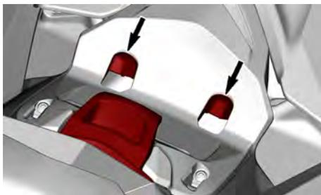
Para instalar o sistema de áudio, primeiro insira as linguetas frontais de travamento e depois empurre para baixo para encaixar a alavanca de trava completamente.
