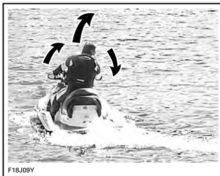
Virar o guidão gira o bocal da bomba de jato, que controla a direção da embarcação. Virar o guidão para a direita virará a embarcação para a direita e vice-versa. Você precisa acionar o acelerador para virar.
