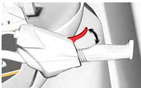
A alavanca do acelerador é acionada por mola e deve voltar à posição de descanso quando não estiver pressionada.
