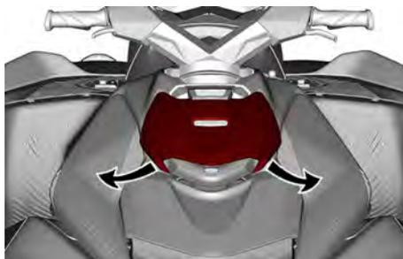
4. Deslize a tampa (na direção da parte dianteira da moto aquática).
