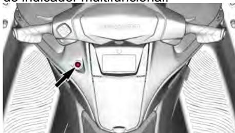
Para permitir a partida do motor, a tampa do cabo de segurança deve estar encaixada firmemente no interruptor de desligamento do motor.
