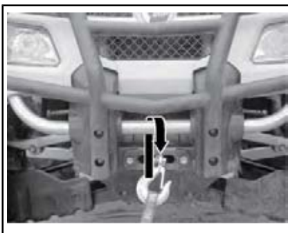
TÍPICO — UBICACIÓN DEL PUNTO DE ANCLAJE DELANTERO
