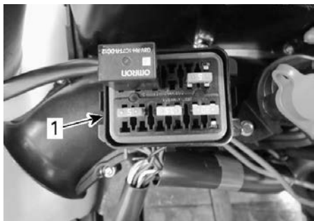
SITUAZIONE TIPICA - COPERTURA DELLA SCATOLA FUSIBILI RIMOSSA
