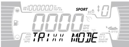
Le mode SPORT offre une réponse instantanée de l'accélérateur et des accélérations plus vives que le mode PAR DÉFAUT . Le Mode Trixx augmente la réactivité de l'IBR. La vitesse en marche arrière est augmentée et le comportement au freinage est également différent.
