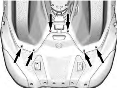
12. Retirez les dix écrous et vis M6 des deux côtés du corps central.
