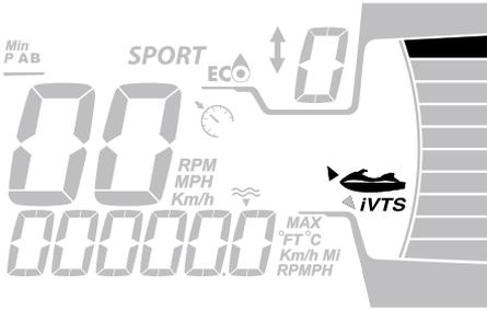
Pour sélectionner la position la moins élevée, double-cliquer sur la flèche du bas sur le bouton (proue abaissée).
