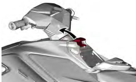
2. Faites glisser le couvercle vers le haut en direction du levier du verrou. Il doit s'enclencher dans sa position.
