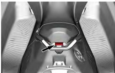
Le retrait du siège permet d'accéder à l'extincteur (non fourni) et au bouchon du réservoir de carburant.
