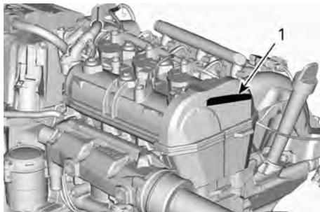
1. Numéro d'identification du fabricant du moteur
