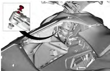
5. Retirez les vis de l'assemblage du câble.
