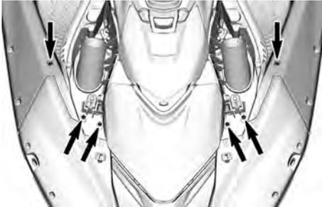
11. Retirez les six vis autotaraudeuses à l'arrière du corps central.
