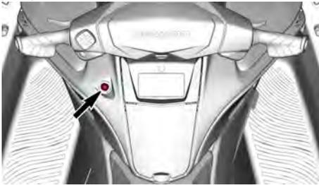
Pour que le moteur démarre, le capuchon du cordon d'attache doit être solidement fixé à l'interrupteur coupe-circuit du moteur.
