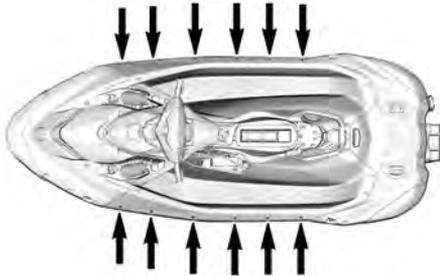
13. Soulevez avec précaution le corps central de la coque à l'aide d'une sangle de levage appropriée.
