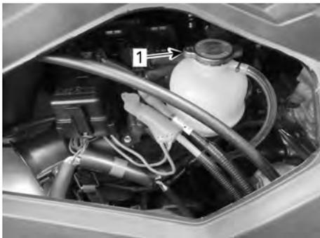
1. Bouchon de réservoir d'expansion
