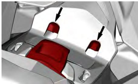
Pour installer le système audio, commencez par l'insérer dans les languettes de fixation avant, puis poussez vers le bas pour engager complètement le levier de verrouillage.
