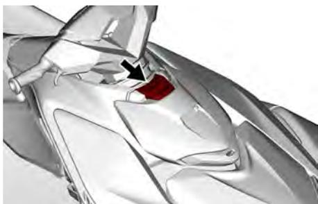
4. Assurez-vous que la languette avant est ancrée dans la fente de la console avant.
