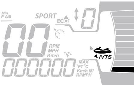
La position d'assiette intermédiaire doit être sélectionnée en fonction de la position d'assiette réelle. Double-cliquez sur le bouton HAUT VTS si la position est en dessous de l'assiette intermédiaire ou double-cliquez sur le bouton BAS VTS si la position est au dessus de l'assiette intermédiaire.
