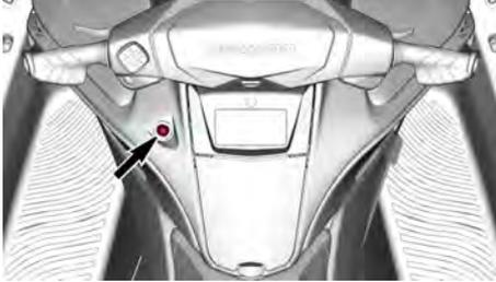
Um den Motor starten zu können, muss die Haltegurtkappe sicher am Motorausschalter befestigt sein.
