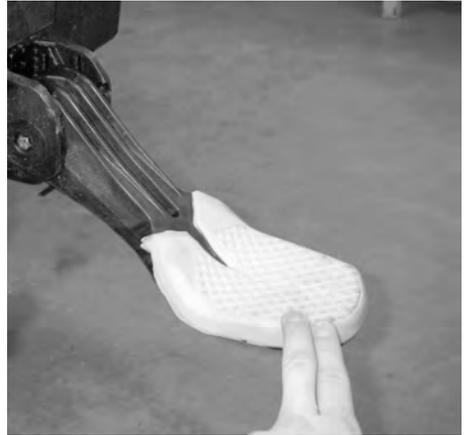
**HERUNTERGEKLAPPTER AUFSTIEGETRITT ZUM BESTEIGEN AUS DEM WASSER HERAUS**
