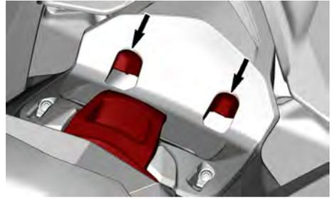
Um das Audiosystem einzubauen, setzen Sie es zunächst in die vorderen Verriegelungslaschen ein und drücken es dann nach unten, um den Verriegelungshebel vollständig einrasten zu lassen.
