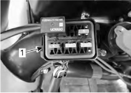
**TYPISCH - SICHERUNGSKASTEN ENTFERNT**
