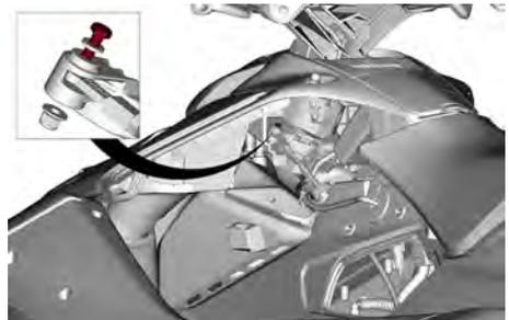
5. Entfernen Sie die Schrauben der Kabelbaugruppe.
