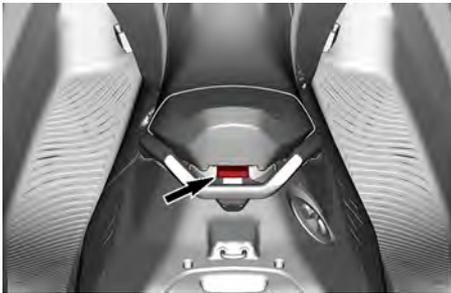
Der Ausbau des Sitzes ermöglicht den Zugriff auf den Feuerlöscher (nicht mit dem Fahrzeug geliefert) und die Tankkappe.
