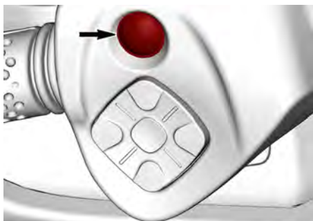
TÍPICO - BOTÓN DE ARRANQUE/PARADA DEL MOTOR
