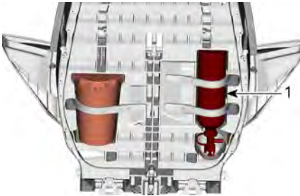
1. Extintor de incendios
