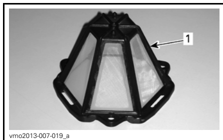
1. Filtre à air de la transmission CVC
